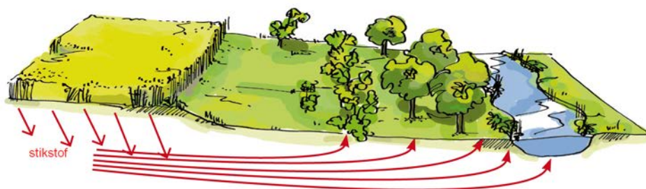
Figuur 2.3. Het vasthouden en verwijderen van stikstof in een beekdal. De meststikstof uit grasland wordt op weg naar de beek voor een deel door de begroeiing opgenomen en verdwijnt voor een deel naar de lucht, een 20-95% effectieve verwijdering. Hoe breder het beekdal, hoe meer verwijdering. (Bron: Verdonschot 2010).
