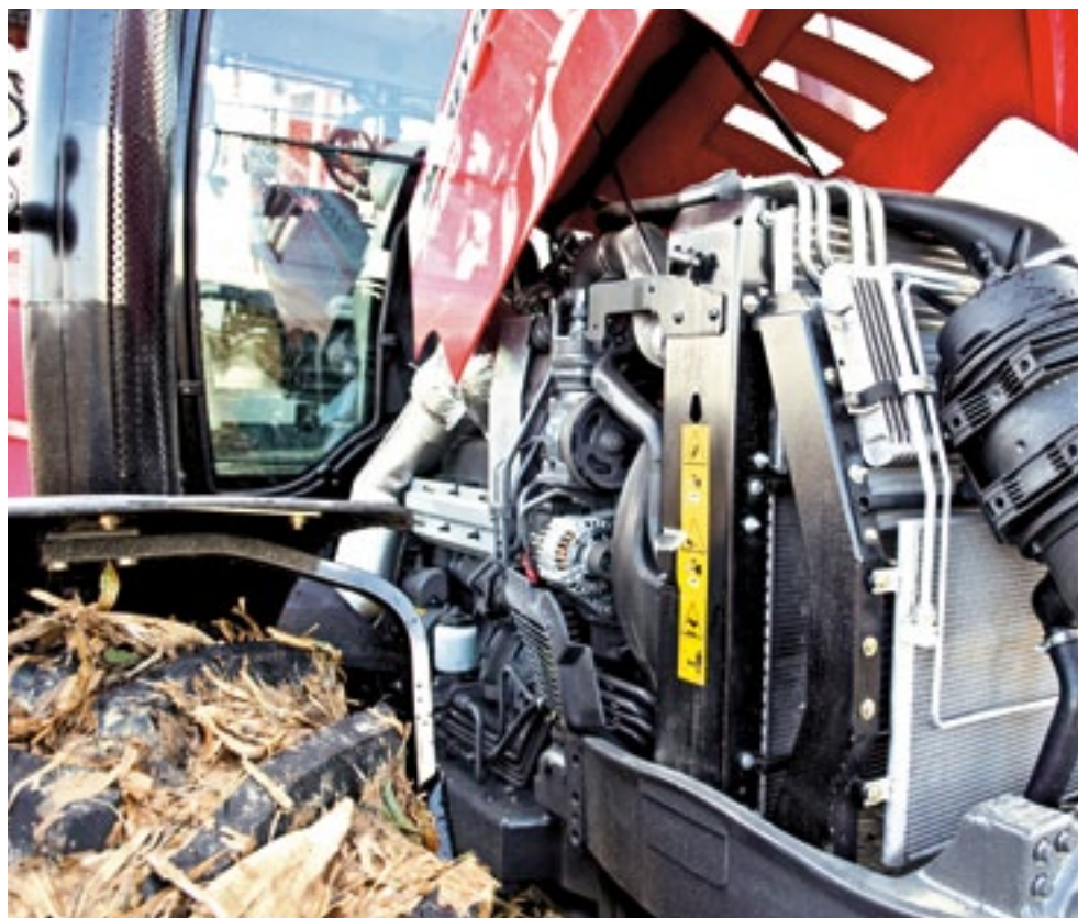
▲ Onder de motorkap ligt een Sisu zescilindermotor met SCR, AdBlue en een dieseloxydatiekatalysator. Let ook op de ovale uitlaat langs de gebogen voorruit. De vorm houdt hem uit het zicht van de bestuurder.
