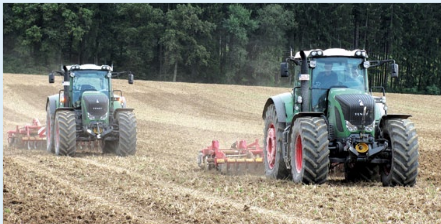
▲ Via de Fendt Vario-Terminal stelt de bestuurder bij toepassing van Fendts Guide Connect, een master/slave combinatie of elektronische dissel, de volgfstand in ten opzichte van de eerste bestuurde trekker en de werkbreedte van de machines achter de trekkers. Ook moet hij aangeven welke van de twee trekkers onbemand zijn werk doet. Om obstakels te mijden kan de chauffeur op de eerste trekker de volgende trekker opdracht geven tijdelijk exact te volgen in plaats van volgen in de volgende werkgang. Daarnaast krijgt de bestuurder te zien hoe snel de tweede trekker rijdt en hoeveel toeren de motor maakt. Ook als de diesel op dreigt te raken, geeft de trekker een seintje.
