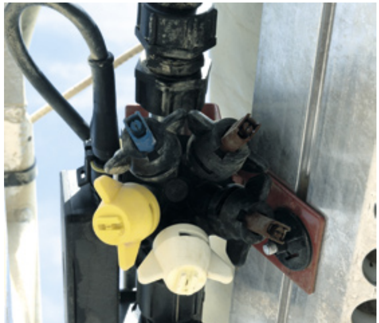
■ De meervoudige dophouder is een bekende techniek. Deze dophouder is elektrisch aangestuurd om pleksgewijs via een gps-sigitaal de dop te openen of te sluiten.
