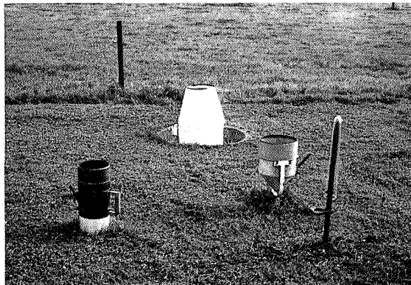
Figuur 3 Verschillende typen regenmeters opgesteld op standaardhoogte van 40 cm boven maaiveld op station Hupsel
