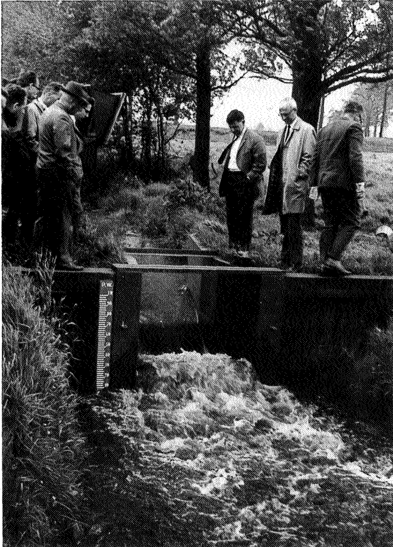
Figuur 5 Parshall-flume in meetpunt 10, het lozingspunt van het Hupselse Beekgebied, voor de beekverbetering (voor de situatie na de beekverbetering, zie Figuur 7)
