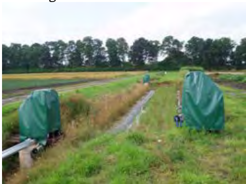
Beekbegeleidend vloeiveld met debietproportionele meetapparatuur (3x)
