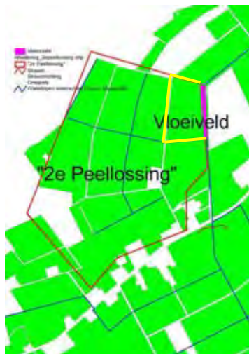
Figuur 4.1. Zuiveringsmoeras en aanvoer van water. Er zijn twee opties: of er wordt alleen water uit de direct aangrenzende percelen gezuiverd of ook water aangevoerd via de Middenpeellossing. De wateraanvoer vanuit de Middenpeellossing kan met een schuif worden geblokkeerd.
