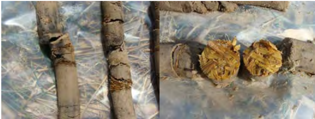
Foto-overzicht 2.7. Laagjes stro in horizontaal zuiveringsmoeras met stro na 5 jaar.
