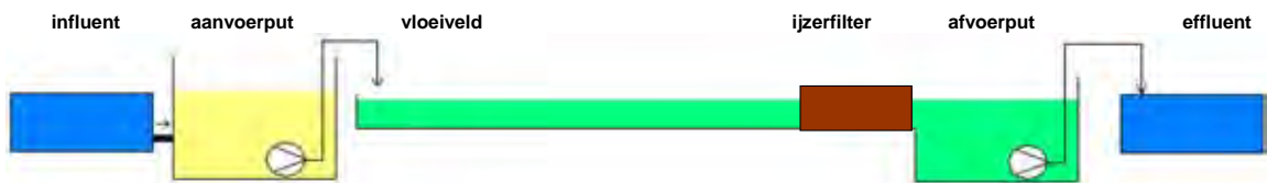
Figuur 4.3 Schematisch overzicht pompbesturing
