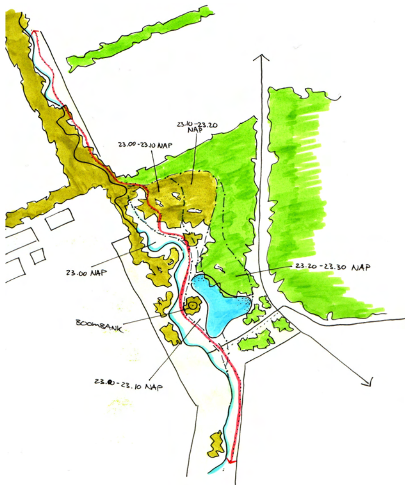
figuur 1: schetsontwerp vergraving perceel "helofytenfilter"
