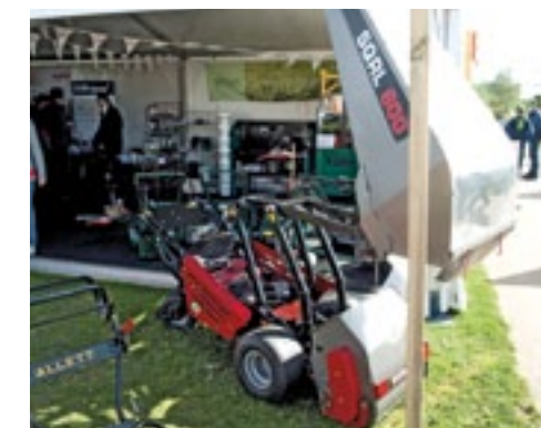
Het Engelse Allet bouwt al jaren Turfmech machines. De Nederlandse importeur Milati Grass Machines uit Papendrecht importeert nu voor het eerst de SQRL 600. Deze driewielige machine ruimt de 'cores' op die achterblijven na het beluchten van de green of de tee. In tegenstelling tot reeds bekende machines, hangt hij niet aan de trekker, maar loopt je erachter. De SQRL600 heeft een werkbreedte van 60 cm en veegt de resten in een 0,35 m 3 grote verzamelbak die kan kiepen. De machine is 94 cm breed en 240 cm lang. Hij is voorzien van een 9,6 kW (13 pk) benzine-motor en kost 16.000 euro.
