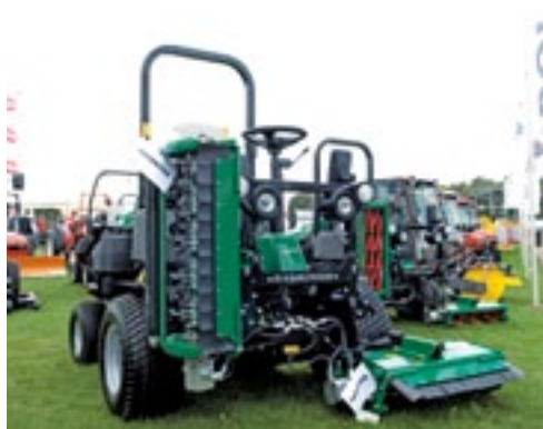
Ransomes rust een kooimaaiër uit met klepelunits. Via de Parkway 3 speelt de fabrikant zo in op de door bezuinigingen ingegeven trend om minder vaak te maaien. De overtop draaiende en hydraulisch aangedreven klepelmaaiers moeten voor een mooi maai-beeld in lang gras zorgen. Daarnaast legt de maaier het gras vaak te maaien. De overtop draaiende en hydraulisch aangedreven klepelmaaiers moeten voor een mooi maai-beeld in lang gras zorgen. Daarnaast legt de maaier het gras vaak te maaien. De overtop draaiende en hydraulisch aangedreven klepelmaaiers moeten voor een mooi maai-beeld in lang gras zorgen.
