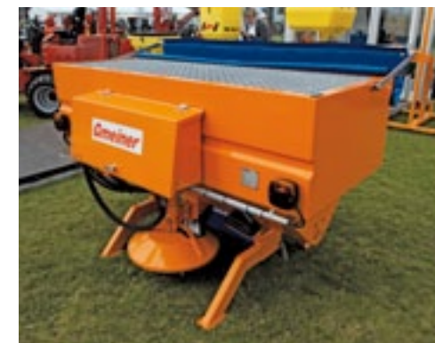
Importeur Kruse uit Ootmarsum levert de Geminer Tracon zoutstrooiers. De machines hangen in de driepuntshef van de trekker. Bevestigings-elementen, beschermkappen, de strooischotel en de geleideplaat zijn gemaakt van roestvast staal. De bak van de Traco 1000 heeft een inhoud van 1 m 3 . Er zijn ook strooiers met een 2-kuubs bak leverbaar. In alle gevallen zijn er twee versies: de TS voor droog zout en de FS voor vochtig zout. Een strooi-computer is standaard en de strooibreedte is instelbaar van 1 tot 8 meter. De dosering is afhankelijk van de rijnsnelheid. De Traco 1000 kost 9.500 euro.
