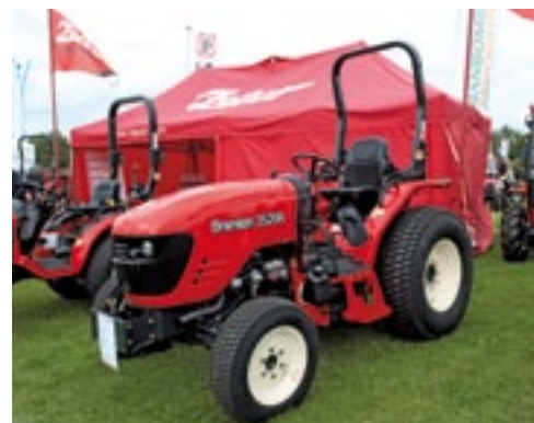
Slootsmid stelde de splinternieuwe Branson 20-serie voor. De serie bestaat uit vijf trekkers van 23 kW (31 pk) tot 41 kW (55 pk) met onder meer een nieuw uiterlijk. Slootsmid toonde het topmodel, de 5520R en de 26 kW (35 pk) sterke 3520R. Die trekker heeft vierwiel aandrijving, een gesynchroniseerde versnellingsbak met 12 versnellingen voor en achteruit en een omkeer. De hef tilt maximaal 1.500 kg. De maximumsnelheid van deze Zuid-Koreaanse trekker bedraagt 24 km/h. Verder hebben alle trekkers uit de 20R-serie een nieuwe vooras met 60 graden wieluitslag voor manoeuvreerwerk op de (spreekwoordelijke) vierkante millimeter.
