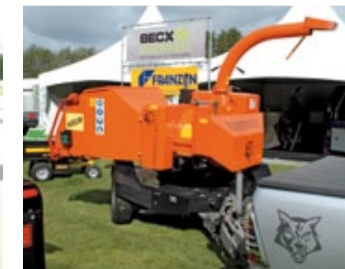
Het in Engeland gevestigde Timberwolf introduceert op basis van een enkelassige aanhangwagen een nieuwe versnipperaar met een capaciteit van 12 ton per uur en een gewicht van 2,2 ton. De machine draait 360 graden op het onderstel. Deze versnipperaar, die 42.500 euro kost, heeft een luchtgekoelde dieselmotor van 49 kW (65 pk). Het toerental van de rotor met vier messen van 180 mm wordt elektronisch gestuurd en is gekoppeld aan de hydraulische invoerrollen. Bij verstopping draait de rotor automatisch terug. Twee jaar geleden deed Timberwolf zijn intrede in Nederland. Het netwerk bestaat nu uit zeven dealers.
