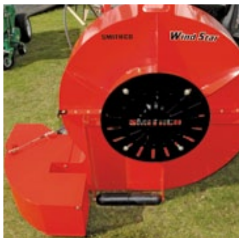
■ De Smithco Windstar (Pols Zuidland) is volledig van metaal, heeft een kleine antiscalpeerrol en kan de luchtstroom 180 graden omkeren middels een klep in de uitblaasopening.
