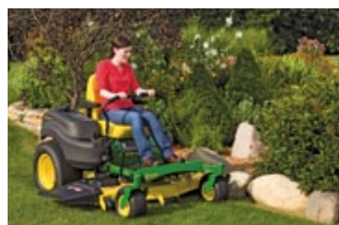
De Z645 zeroturnmaaier heeft een tweecilindermotor van 15,4 kW (21 pk).
