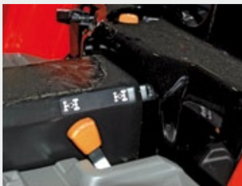
De 4wd is in- of uitschakelbaar. Bij het type Ke is die vierwielaandrijving permanent.
