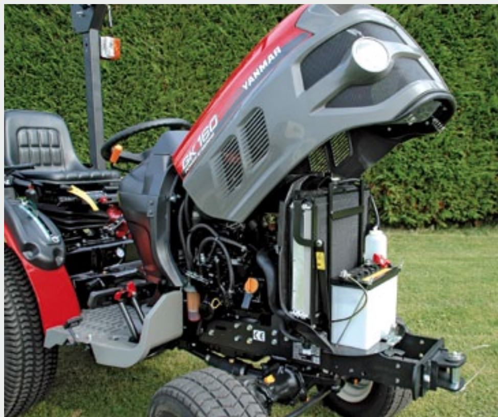
De nieuw vormgegeven motorkap gaat als één geheel omhoog, waardoor de toegankelijkheid van de driecilinder Yanmar diesel valt onder de noemer 'prima'. Er is keuze uit 16 of 20 pk (GK 200).
