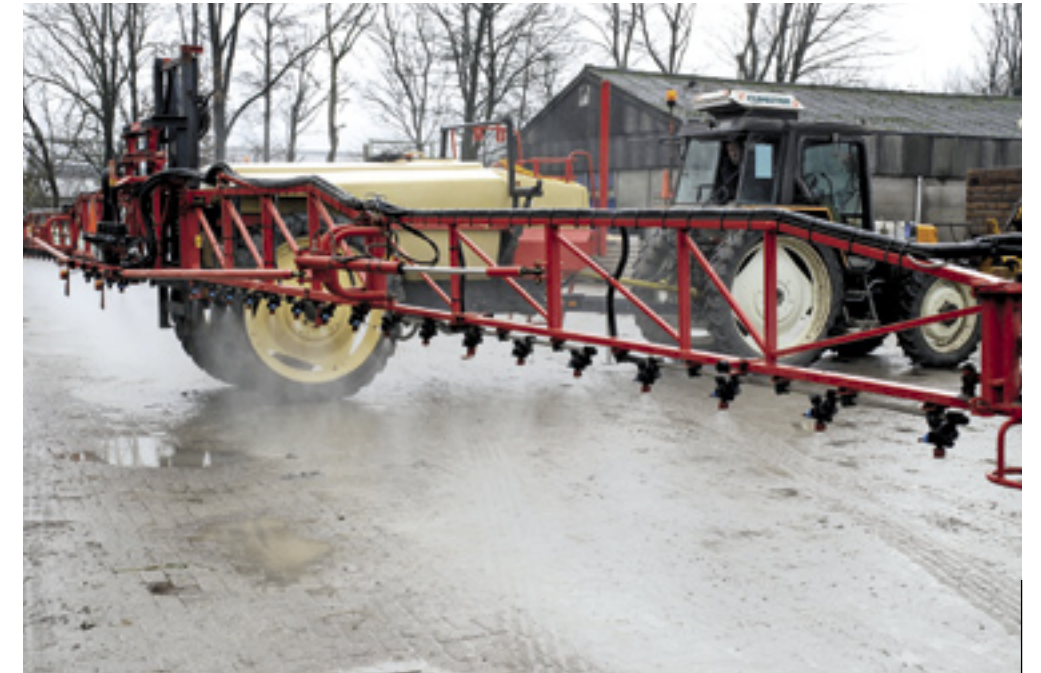
▲ Het winterklaar maken van een spuitmachine begint met uitwendige reiniging en het doorspoelen van leidingen.
