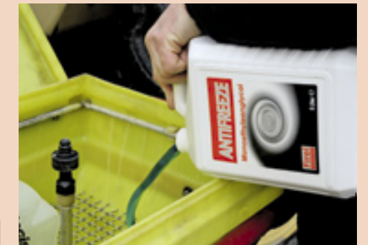
▲ Wanneer alles is schoongemaakt moet je de pomp en leidingen om de pomp vullen met antivries. Dit kan door antivries in de tank te doen en de kranen op roeren te zetten. De fustenreiniger is goed vrij te krijgen van water en door het opzuigen van antivries kun je ook bij dit onderdeel vorstschade voorkomen.
