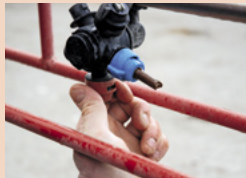
▲ Het beste is om spuitdoppen voor de winter te verwijderen. Reinig ze met een speciale spuitdoppenborstel of een oude tandenborstel en een schoonmaakmiddel. Haal bovendien de anti-nadruppelmembraan van een revolverdop los om ook dit stukje leiding leeg te laten lopen.
