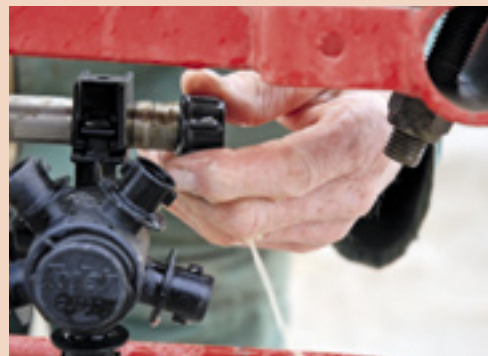
▲ Verwijder de eindstoppen van de sectieleidingen, zodat je deze kunt doorspoelen. Een aandachtspunt hierbij is dat er vooral bij het gebruik van poedervormige gewasbeschermingsmiddelen nog wel eens reststoffen willen ophopen.
