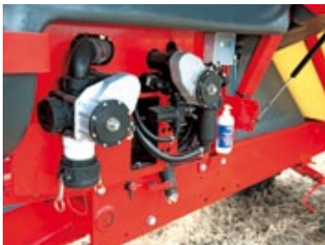
▲ Onder een opklapbare kunststof klep is de bediening van de spuit te vinden.
