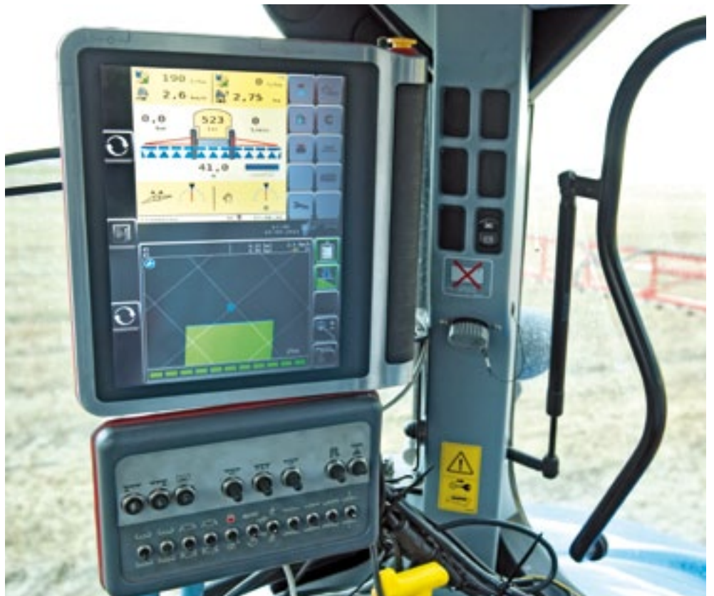
▲ De Tellus bedieningsterminal van de nieuwe Kverneland iXtrack spuit. De spuitmachine is voorzien van automatische sectieafsluiting en gps. Overlap wordt zo tot een minimum beperkt.
