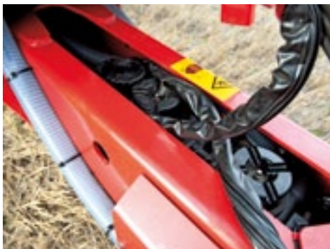
▲ De pompen zijn in de geveerde dissel, met boven- of onderaanspanning, gebouwd.
