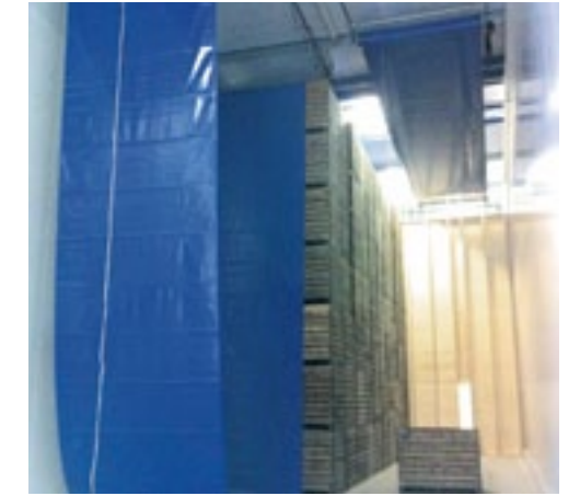
▲ Systeem 3: Een motor aan een rail zorgt ervoor dat het zeil het product volledig kan afdekken.
