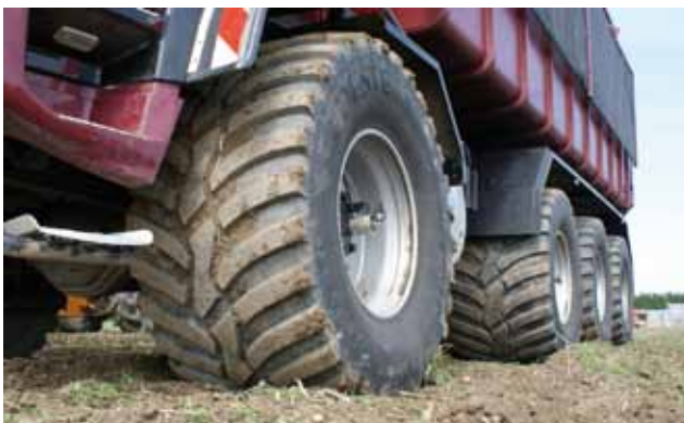
◀ De combinatie staat op Vredesteins, 650/55R26.5 voor en 750/45R26.5 achter. De combinatie weegt met lege 46-kuubs container 22 ton.
