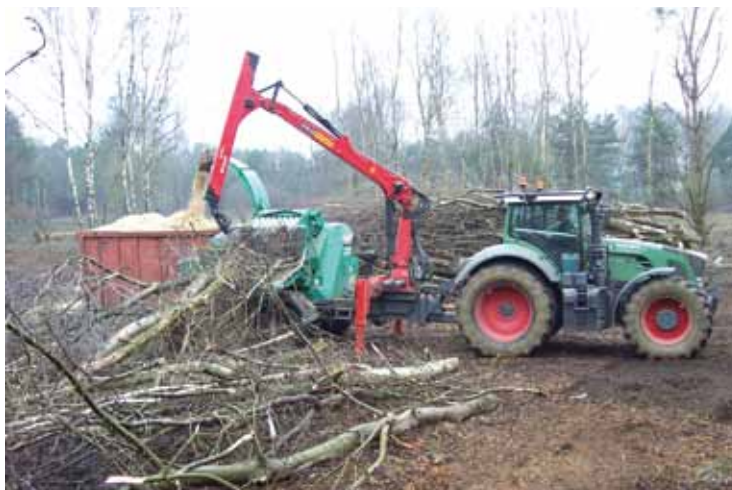
◀ Het chippen van de stammen en de boomkronen. De snippers worden meteen in containers geblazen, zodat er geen grond tussen komt.
