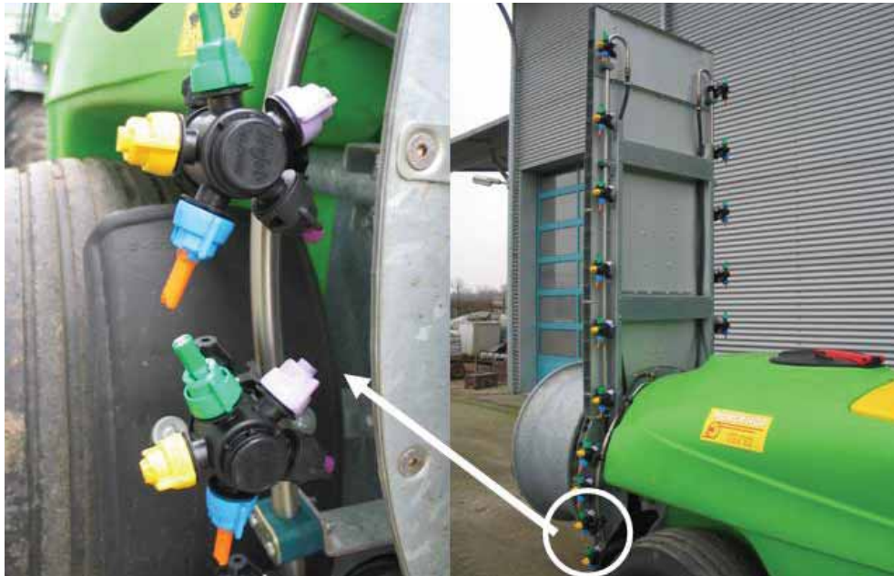
Figuur 2.4. Dwaarsstroomspuit met detailopname draaibare dophouders met de 3 gebruikte spuitdoppen in elke dophouder.
