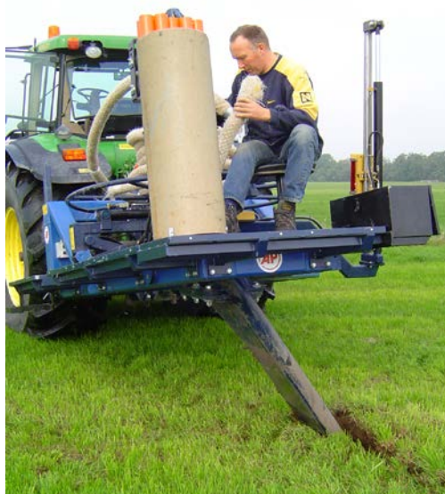
Figuur 24 Draineermachine van loonwerkbedrijf De Vlijt uit Noord Beemster, waarmee ook op grasland sleufloos gedraineerd kan worden
