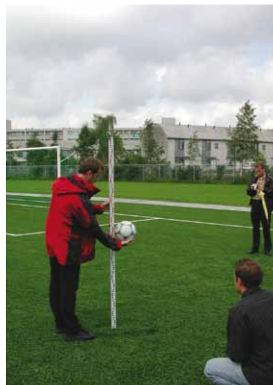
Dankzij een shockpad wordt splashing van infill door een stuiterbal voorkomen.
