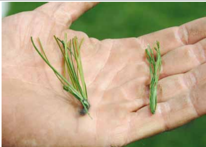
11 Twee typen vezels: rechts gefibrilleerd, links monofilament Fieldturf Duraspine 65GAA.
