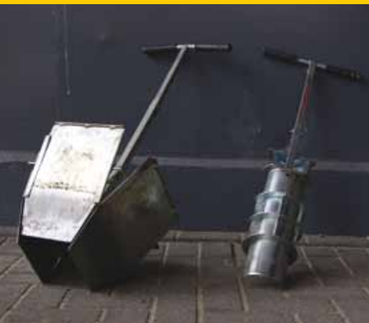
Een holecutter en een turfdoctor.
