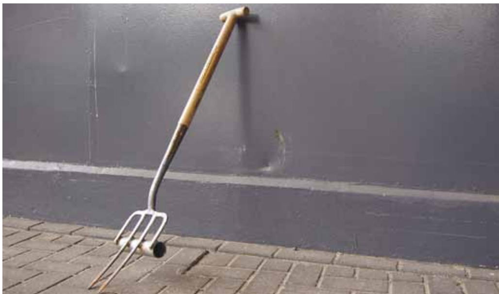
De herstelgreep zoals deze in de Kuip wordt gebruikt is een greep waarvan de buitenste tanden zijn afgezaagd. Om te voorkomen dat de veldverwarming wordt beschadigd, is op 20 cm een buisje op de greep gelast. Dit buisje is bovendien handig bij het aandrukken van de herstelde speelschade.
