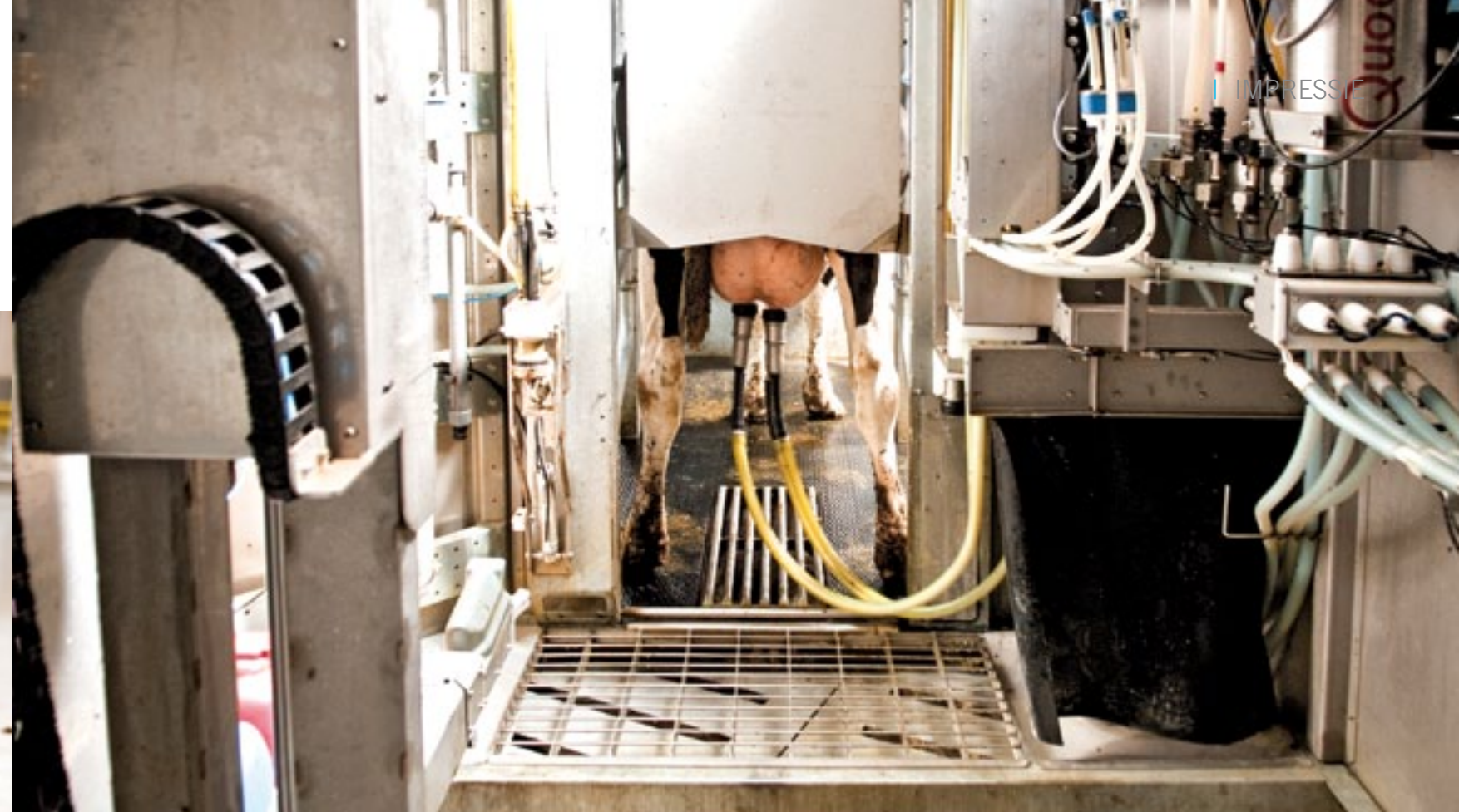
De machinekamer achter de koestand is volledig afgesloten. De robotarm, links op de voorgrond, hangt aan een rail. De arm schuift opzij zodra je de tepelbekers met de hand wilt aansluiten.
