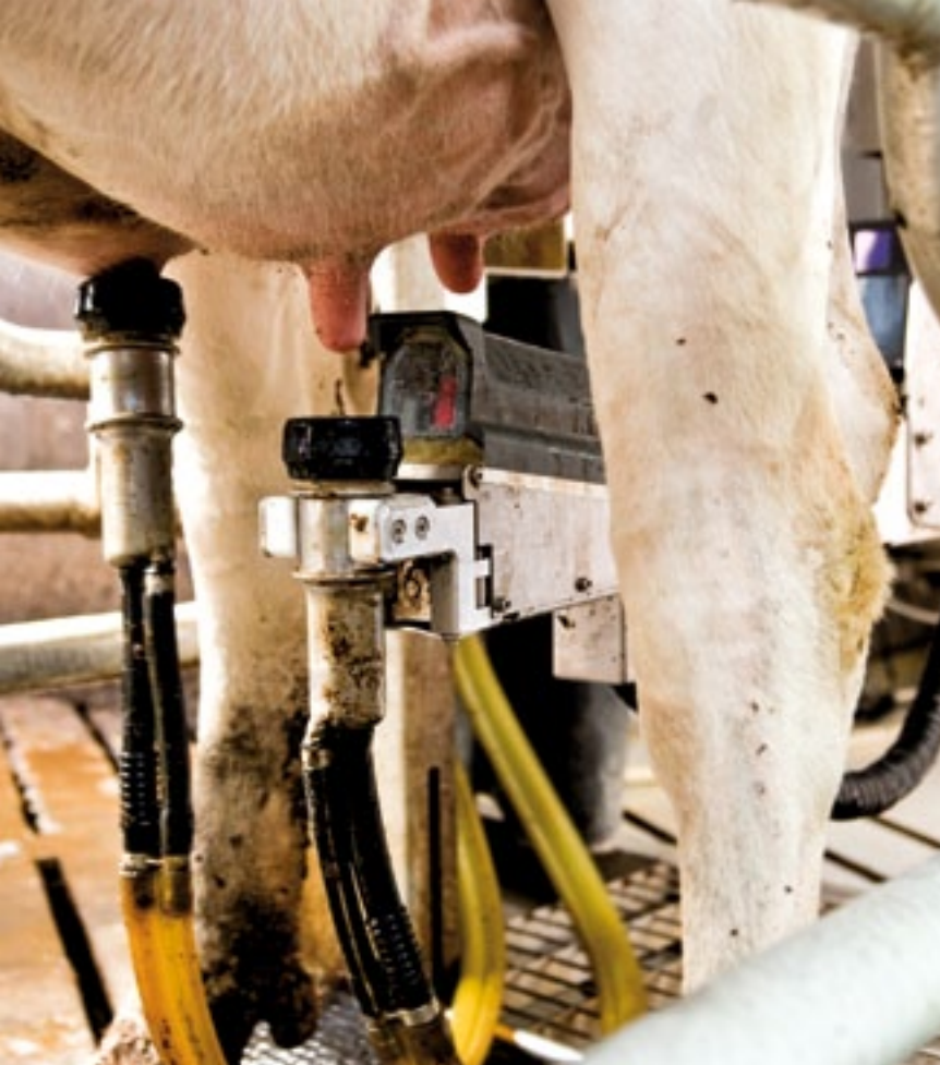
De robotarm sluit de tepelbekers door de achterpoten aan. De kop van de arm zwenkt naar links en rechts.
