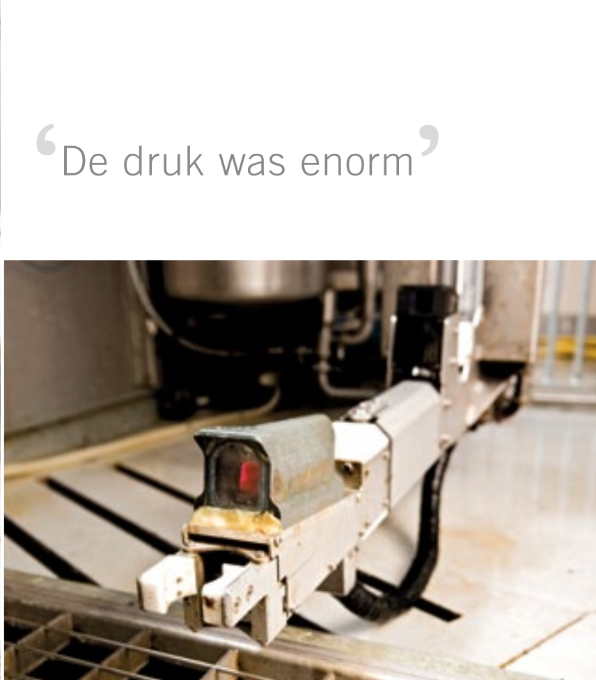
Achterop de robotarm is een 3D-camera te vinden, voorop een camera en laser. Aan de onderkant van de arm zit een sproeikop voor dipmiddel.
