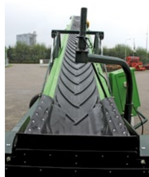
▲ De ML 1970 heeft een graanprofiel en is 19 m lang. Vooraan de koppeling voor de duoband.
