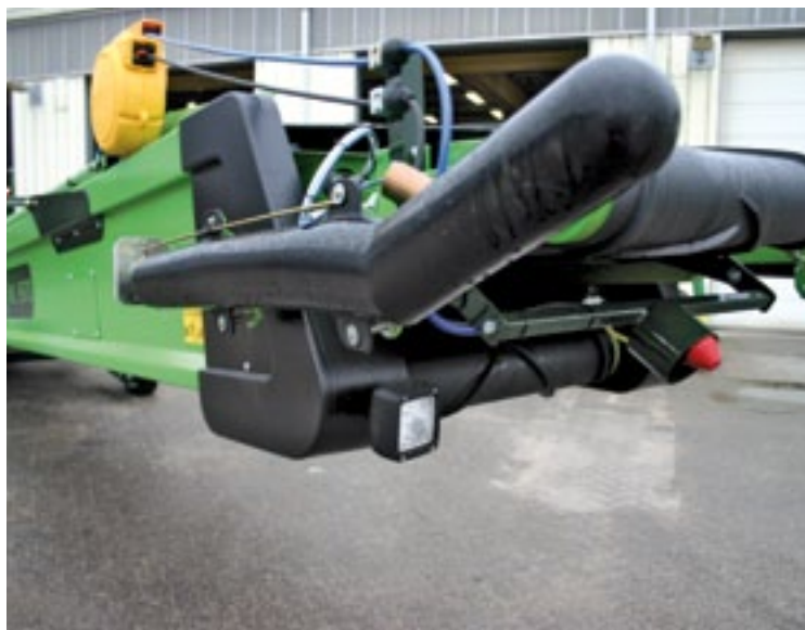
▲ De obstakelbeveiliging zorgt ervoor dat de machine stopt met zwenken zodra het rubber ergens tegenaan komt.
