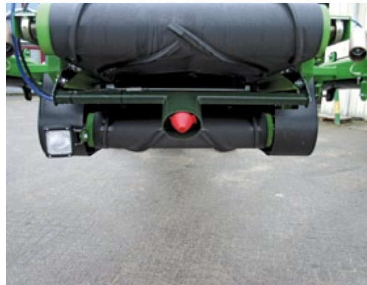
▲ Twee productsensoren controleren de productstroom. Wanneer deze stopt, stopt hij met zwenken en hervat dit zodra de stroom weer op gang komt.
