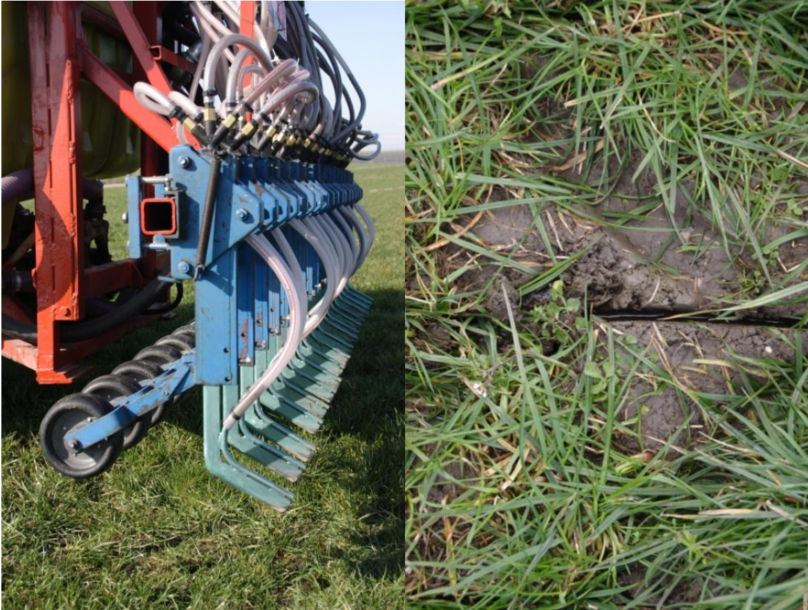
Afbeelding 2 Kouter van proefveldmachine en sleuf in graszode
