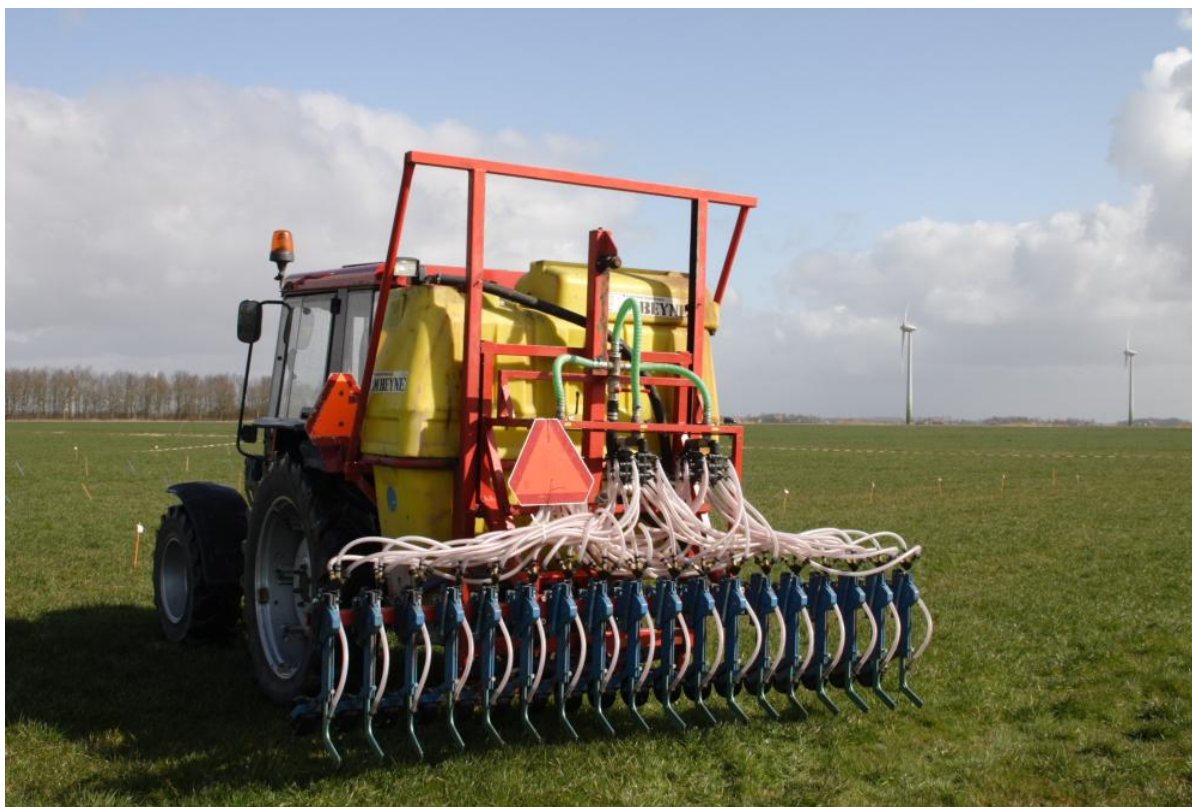
Afbeelding 1 Proefveldmachine voor de toediening van vloeibare meststoffen
