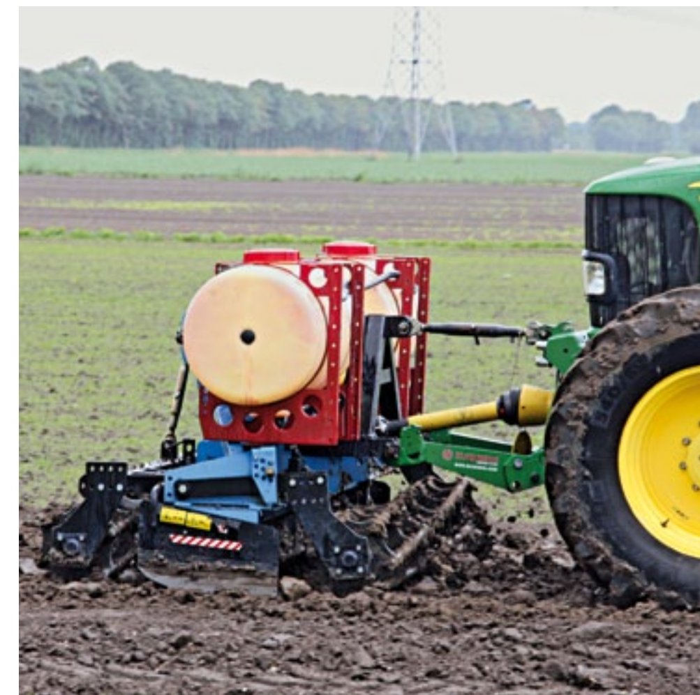
▲ Minder druk op het werktuig in de fronthef vermindert het brandstofverbruik en maakt de trekker beter bestuurbaar.
