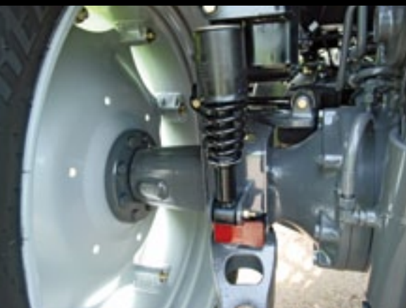
▲ De cabine is optioneel mechanisch geveerd op twee punten. De achteras is minder zwaar dan op andere modellen uit de 5400-serie.
