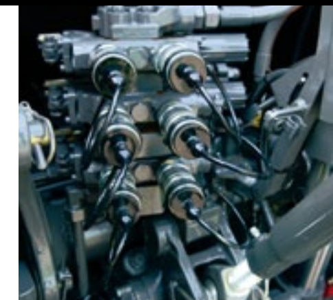
▲ De dubbel werkende hydraulische ventielen zijn in de cabine met een kleur gecodeerd. Achterop de trekker niet. Een gemiste kans.
