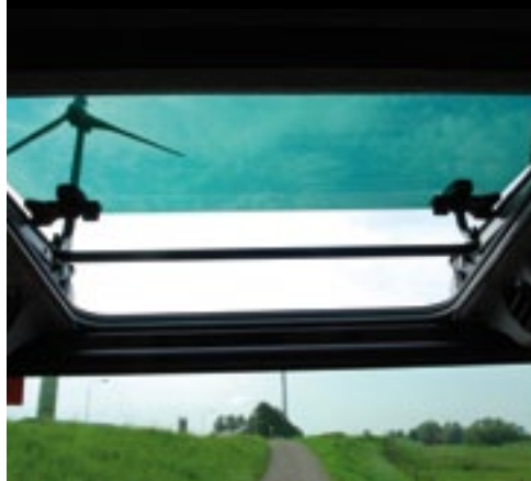
▲ De trekker is uit te rusten met een Visio-cabine. Het dakraam vergroot het zicht op een voorlader en is open te schuiven.
