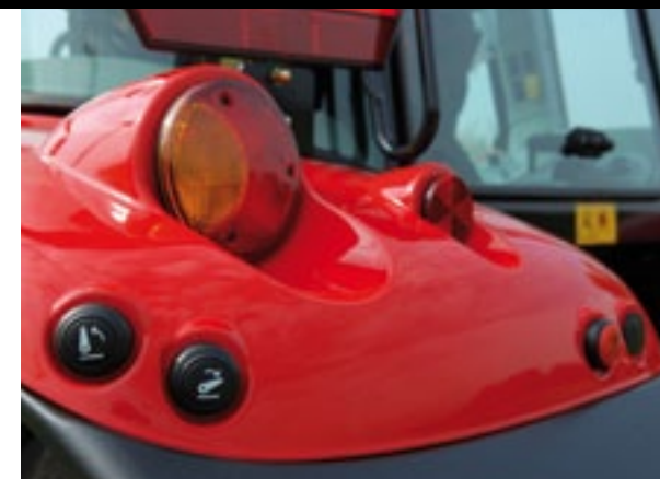
▲ Met knoppen op het spatbord kun je de elektronische hef bedienen. Er is ook een knop waarmee je de aftakas uitschakelt.
