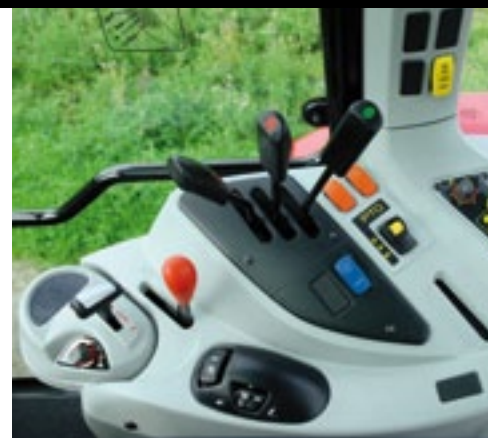
▲ De hydraulische ventielen zijn mechanisch, de hef elektronisch. Schakelen met de Dyna4 transmissie is een genot.
