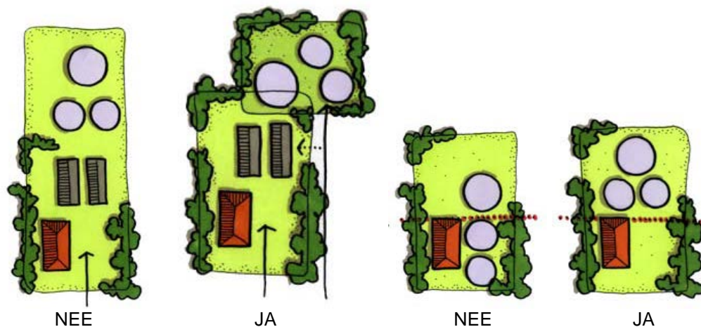
Figuur 10 Voorbeelden van goede en verkeerde plaatsingsvoorbeelden van mestvergisters in het landschap
