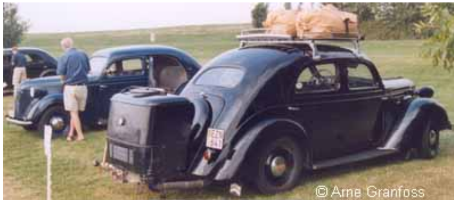
Figuur 1: Toepassing van een houtvergassinginstallatie achterop auto's in WOII.
