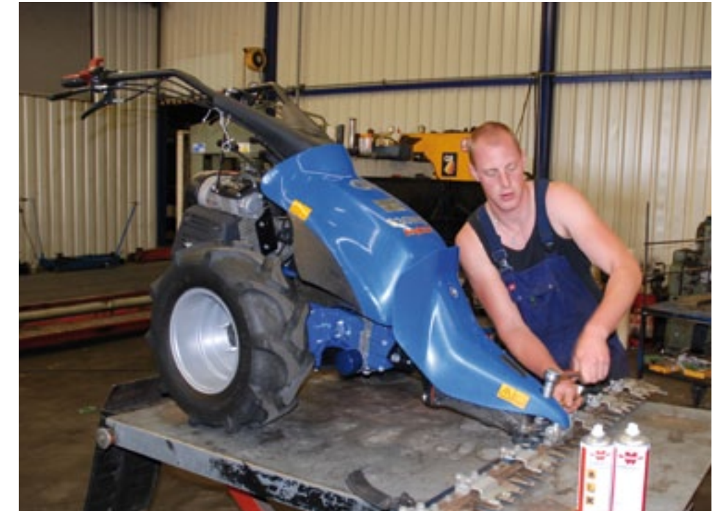
■ Een kopmaaier met messenbalk weegt minder dan een eenasser met klepelmaaier. Ook vraagt een messenbalk minder vermogen, waardoor de werkbreedte groter is. Hij vraagt wel regelmatig onderhoud.
