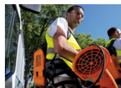
Het aanzuigrooster achterop is via twee schroeven los te maken voor reiniging of vervanging.
