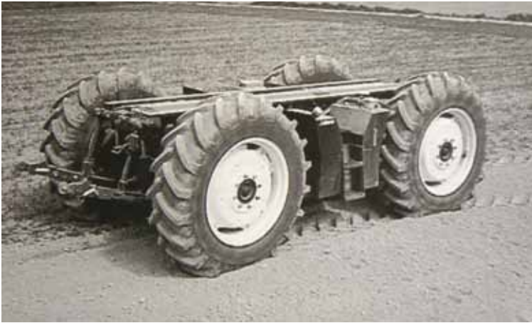
Kone Sampo ontwikkelde deze Module als onbemande trekker met radiografische besturing en een controle-unit, waarmee maximaal 99 trekkers via videomonitoring konden worden gevolgd en bestuurd.
