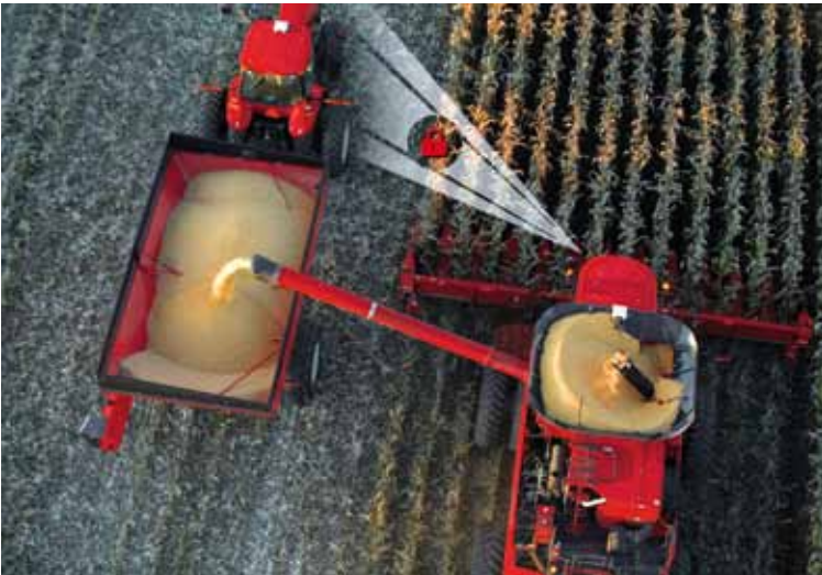
Een belangrijke stap liet Case IH op de Sima zien met zijn concept-V2V-systeem, waarbij de machinist van de combine de regie overneemt van de trekkerchauffeur.
