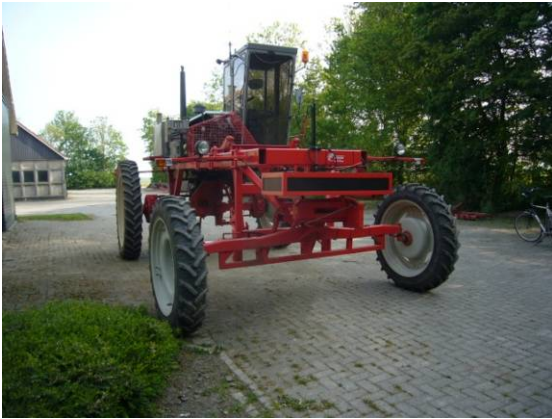
Figuur 2. Aangepaste werktuigendrager voor veldwerkzaamheden.
