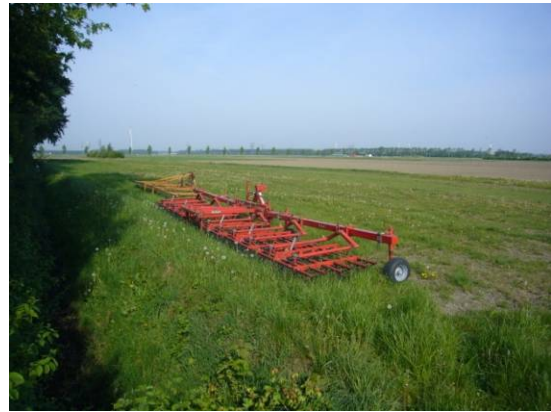
Figuur 3. Twee onkruidегgen; op 6,30 m. en 9,45 m. Werkbreedte.
