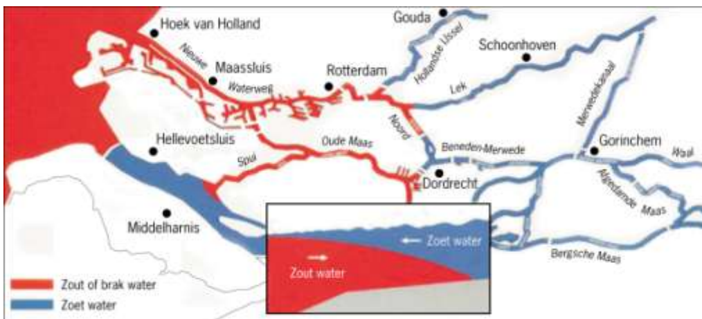
Figuur 1.1 Binnendringen van zeewater in het benedenrivierengebied vanuit de Nieuwe Waterweg in 1991. Inzet: schematische voorstelling zouttong (rood) die door dichtheidsverschil onder het zoete water zakt. Bron: Rijkswaterstaat.
