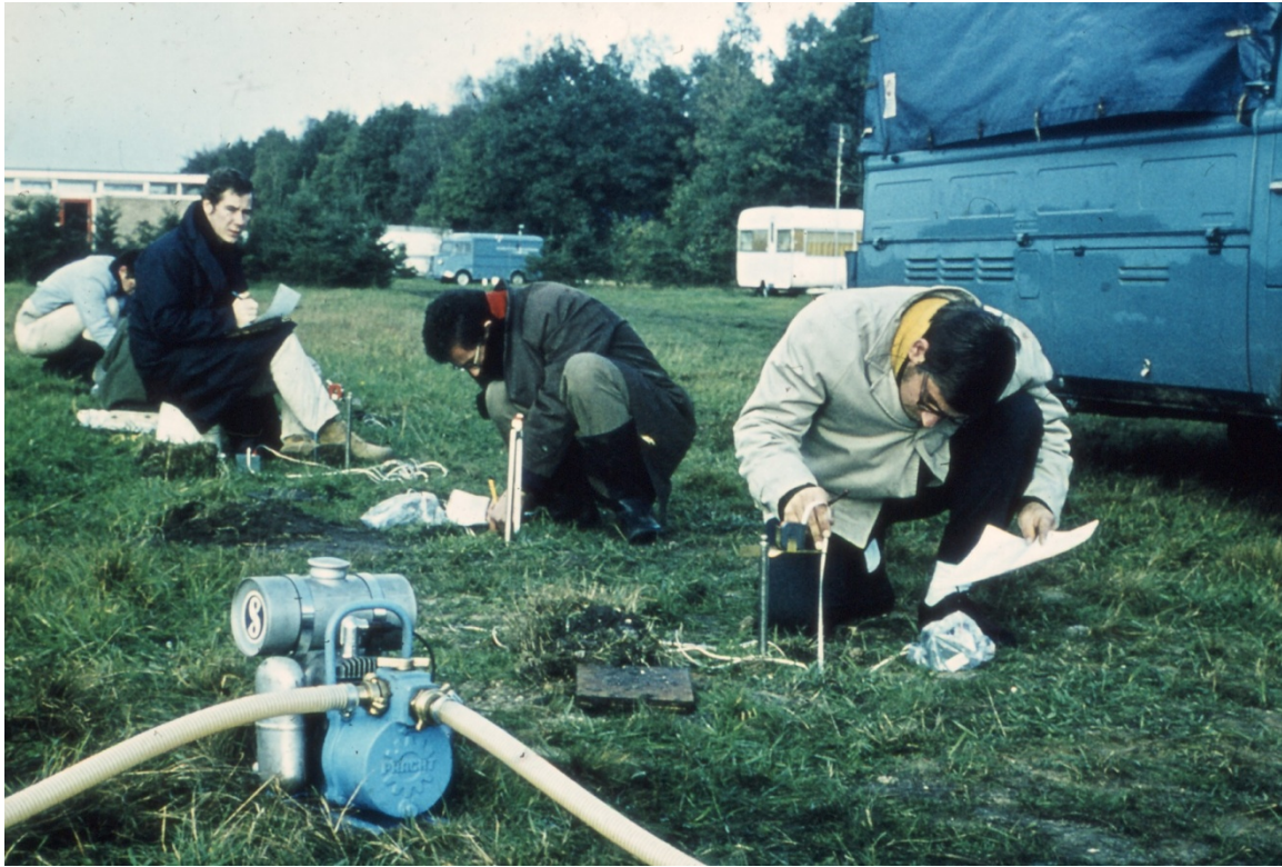
Figuur 25. Uitvoering pompproef in de Hupsel in het kader van het eerste veldpracticum Hydrologie in september 1970. Dit nieuwe onderwijselement werd gemeenschappelijk georganiseerd door de vakgroepen Hydraulica en afvoerhydrologie (Ben Herfst) en Cultuurtechniek (Rinus Jaarsma). Op de achtergrond staat de nieuwe "meetauto" van Hydraulica (dia-archief 3482).
