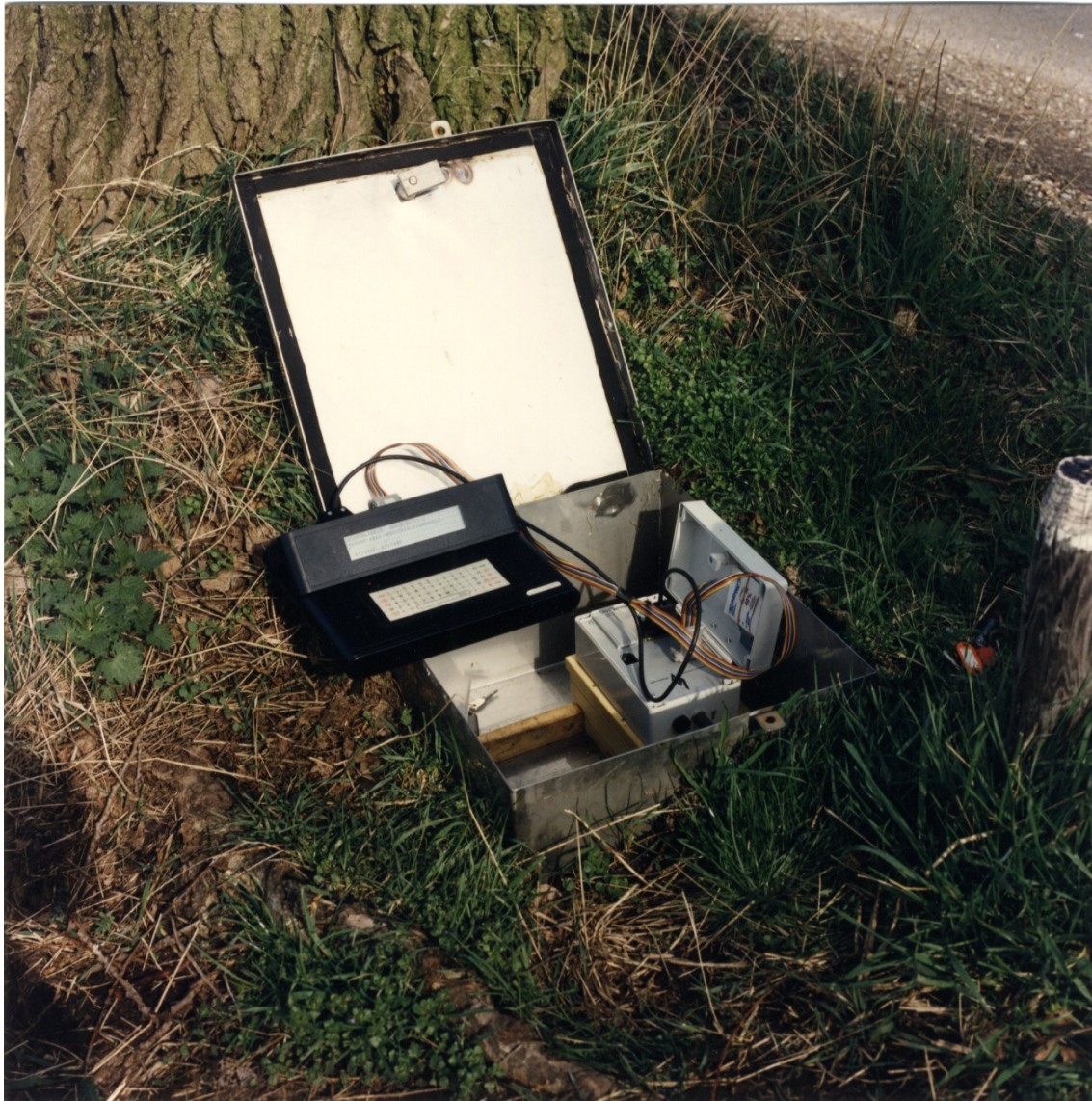
Figuur 27. De PH87 verkeersteller met een afleesunit in een grondkist, geïnstalleerd met telsingang op de Veensteeg
