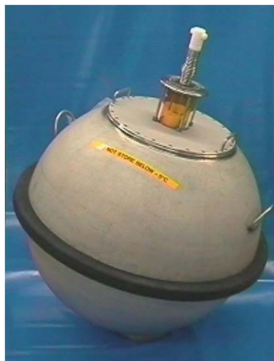
..... Foto 1 MP1 en MP2 directional waverider
