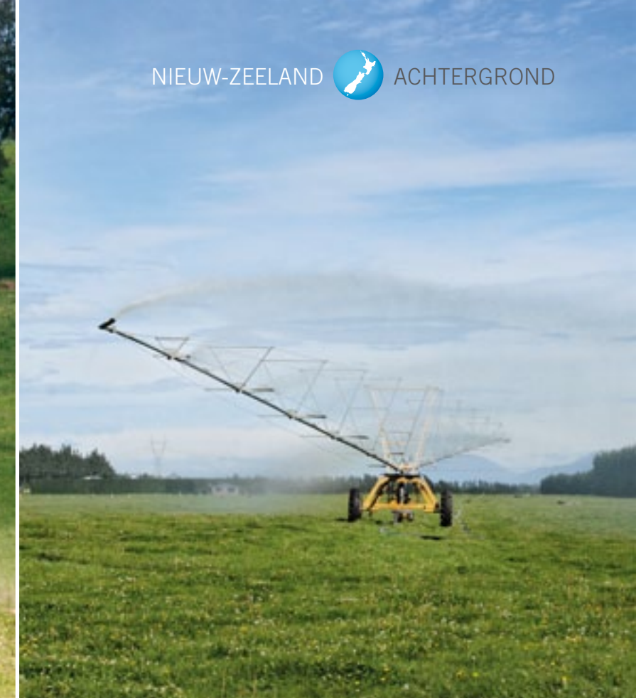
Voor het beregenen draaien er veel draaimolens op een haspel van 100 meter breed die in één trek 3 hectare (100 x 300 meter) beregenen.
