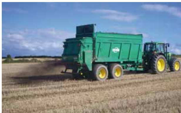
◀ Tebbe heeft zijn strooiers DLG-getest en wijst daarop als het om precisie gaat. Voor precisiestrooien kom je volgens de fabrikant altijd uit op schotelstrooiers.
