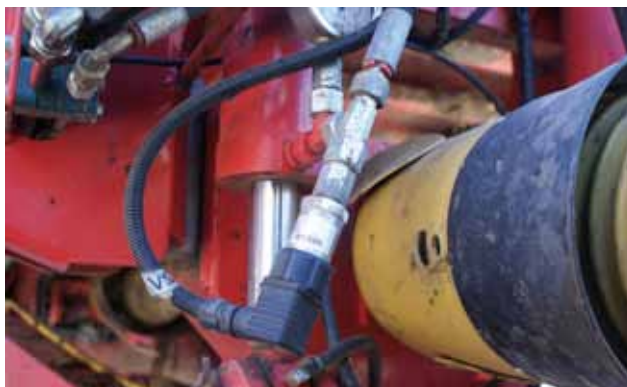
◀ Het systeem werkt met drukopnemers in de hydrauliek van het onderstel en van de disselcilinders. Voor mechanische onderstellen zijn er tussenplaatjes leverbaar.
