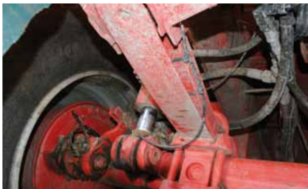
◀ De bestaande wielophanging is onveranderd. Wel is er een sensor geplaatst in de liftas, zodat deze kan worden opgetrokken zonder dat het de weging beïnvloedt.
