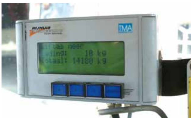
◀ Het display met een plus- en een minknop om de tarra te verrekenen. Het betreft nu nog een pure weging. Rijafhankelijk is er inmiddels ook een GPS-gestuurd doseren zit eraan te komen.
