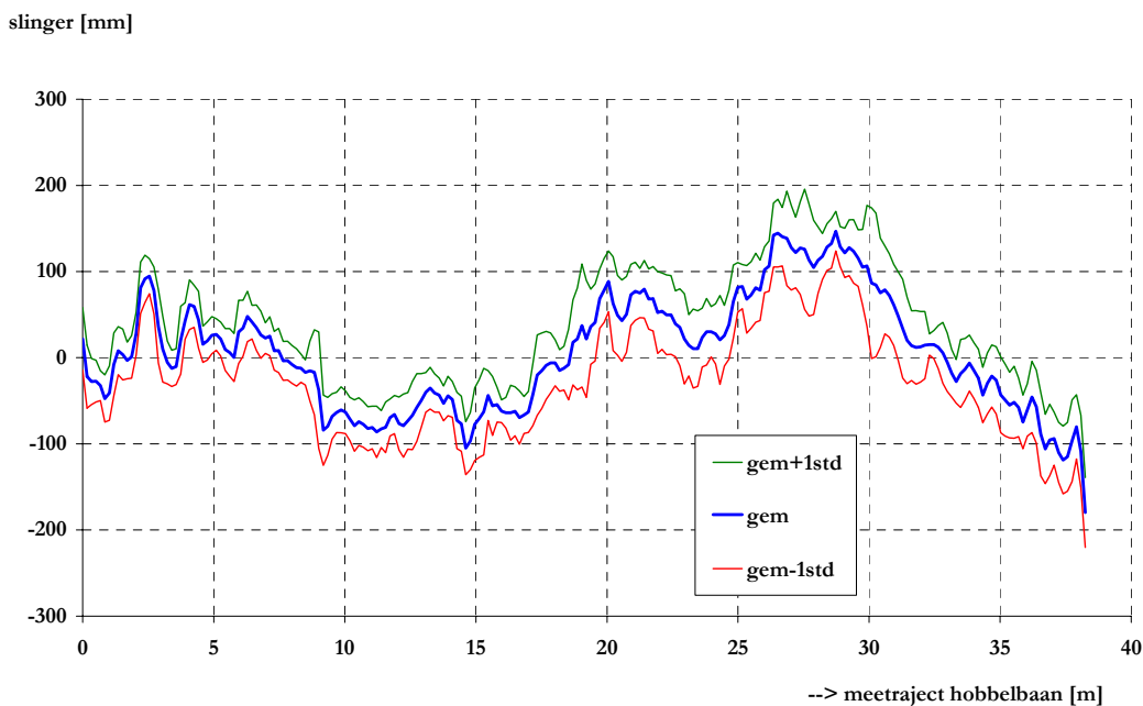
figuur 2: Voorbeeld van gemiddelde van 10 slingerbeweging (+ spreiding = std) gemeten bij 225 cm spoorbreedte op smalle band op de hobbelbaan.
