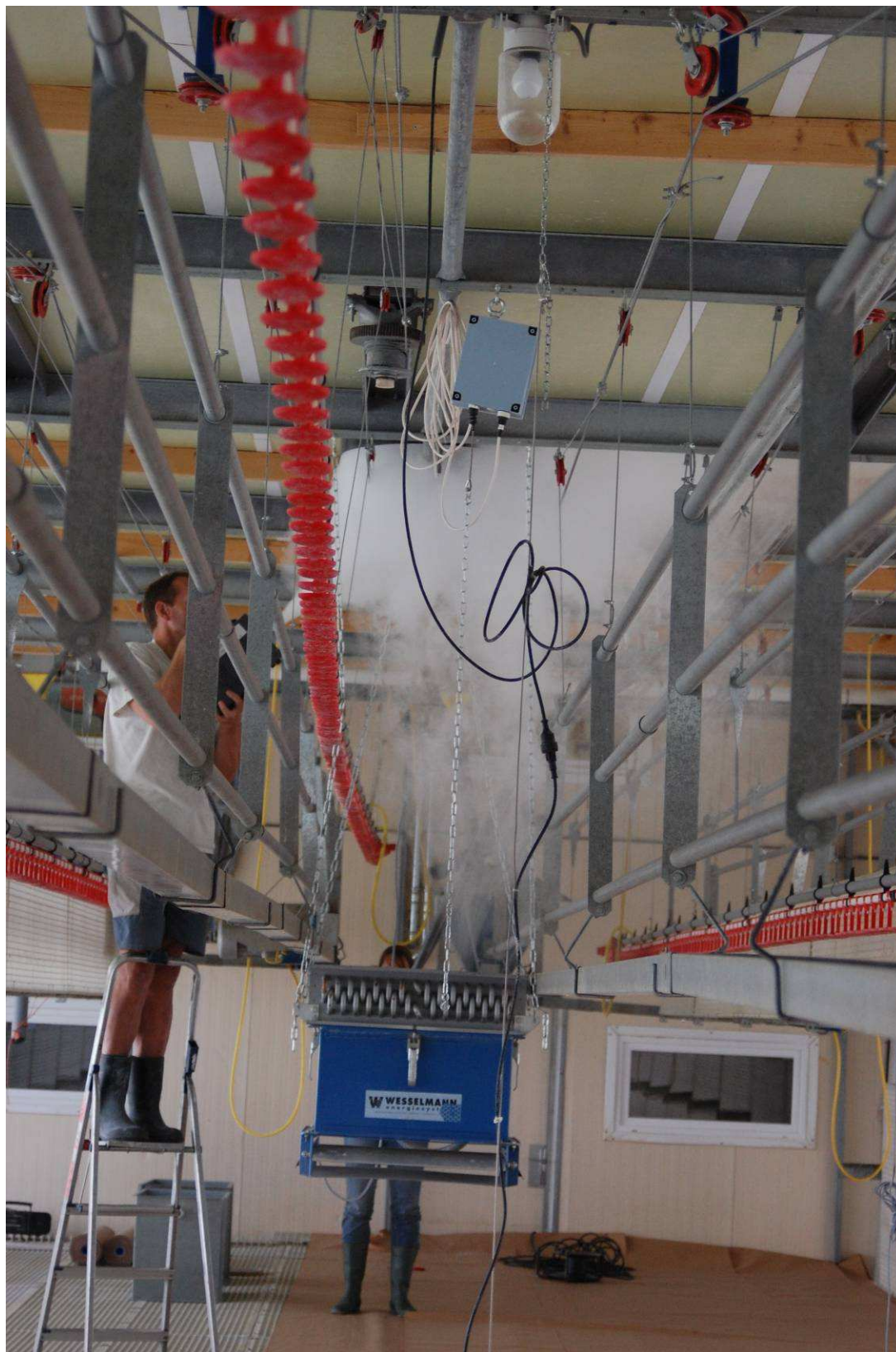
Foto 1 De lucht werd goed vanaf het inlaatventiel naar de kachel getrokken.
