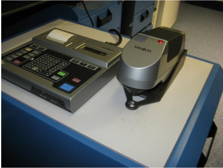
Figuur 10 De chromameter bestaat uit een dataprocessor (links) en een meetkop (rechts).
