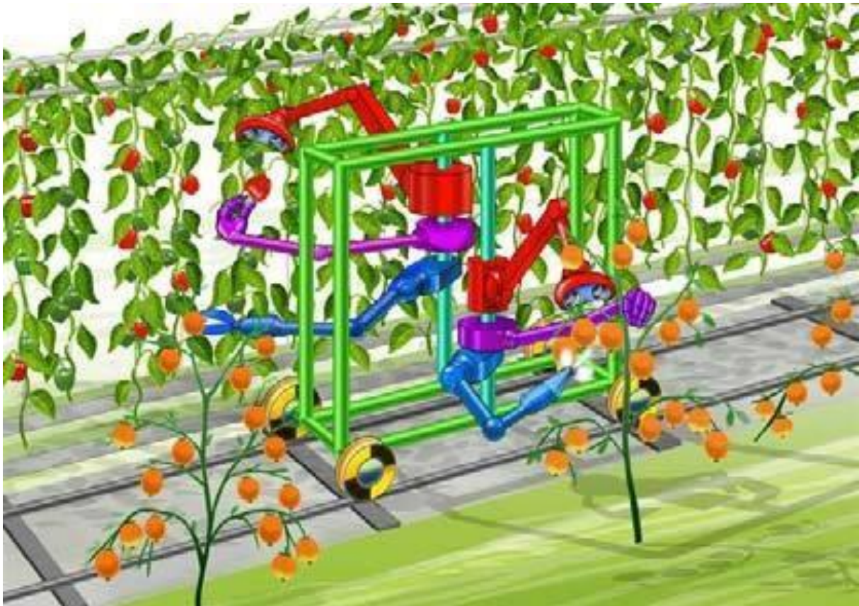
Figuur 1 Artiestenimpressie van de paprikaplukrobot (Crops, 2010).
