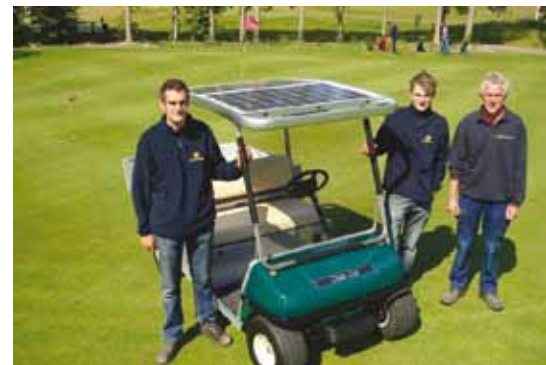
Golfclub Emmeloord nam al in 2009 een Club Car in gebruik die rondrijdt op zonne-energie. De door importeur Jean Heybroek geïmporteerde Golf Car is uitgerust met het Solardrive – systeem.
