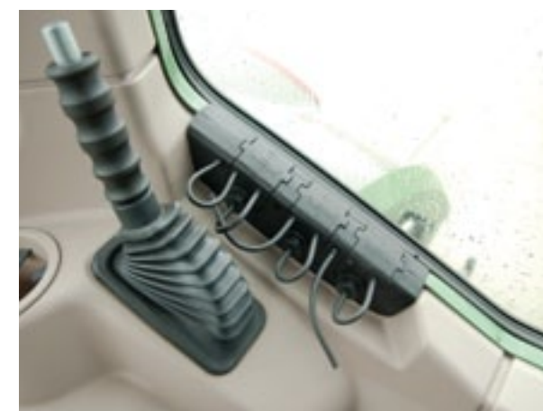
▲ Wil je kabels doorvoeren? Neem het gewenste blokje uit en de kabel verbindt de trekker en de machine geluids-, stof- en waterdicht.
