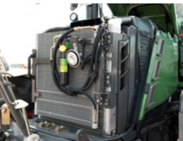
▲ Een warmtewisselaar koelt de transmissie en hydraulische olie. Daardoor is een grotere koelunit te plaatsen, terwijl de motorkap smal blijft.
