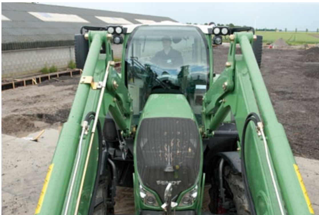
▲ De voorruit loopt door tot in het dak van de cabine. Daardoor heb je goed zicht op de voorlader in zijn bovenste stand. Tegelijkertijd zorgt het voor veel licht in de cabine. Het glasoppervlak bedraagt 6,1 m 2 .
