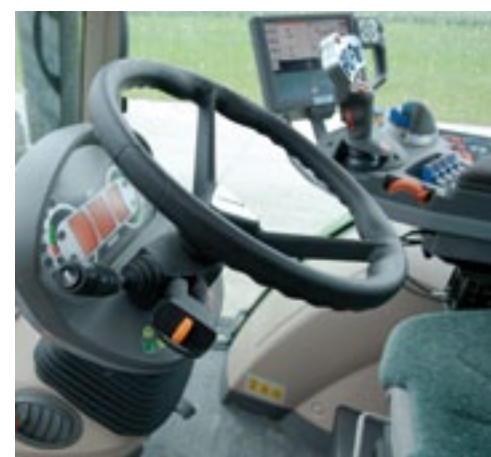
▲ Het stuur is zowel verticaal als horizontaal verstelbaar. Dan beweegt het dashboard mee. De handrem is links op de stuurkolom te vinden.
