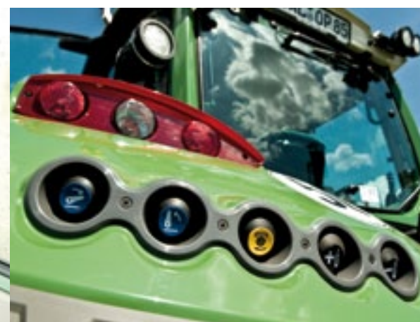
▲ Ledverlichting, in de achterlichten bijvoorbeeld, is een optie. Net als de bediening van een hydraulisch ventiel op het spatbord.
