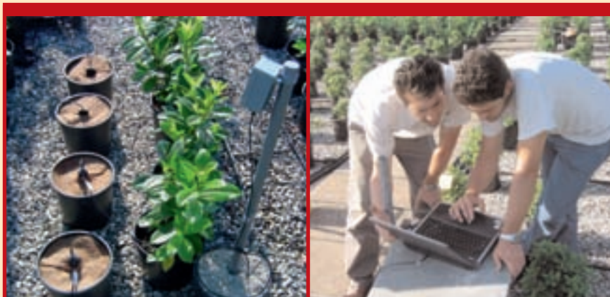
In het Italiaanse Pistoia beproeven onderzoekers van het project Flow-AID de optimale watergift gevoed met gegevens uit een draadloos netwerk van sensoren.
