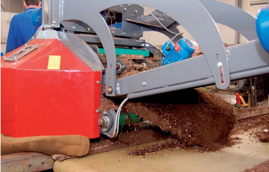
De zaagmachine halveert de inhoud van een kist opkweek. De bovenste helft verdwijnt in de afvalbak, de onderste helft wordt verder geschoond
