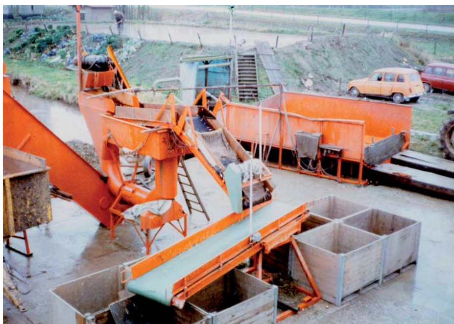
Een impressie van de spoellijn volgens het U-buis-principe waarmee het eerste recirculerende systeem in de bollensector een feit was
