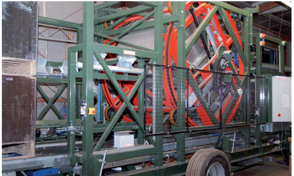
De mobiele unit kan worden gebruikt om tulpen te behandelen met Actellic, maar ook voor de bolontsmetting in het najaar
