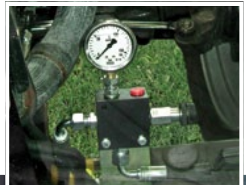
De drukregelunit zit buiten de cabine.
