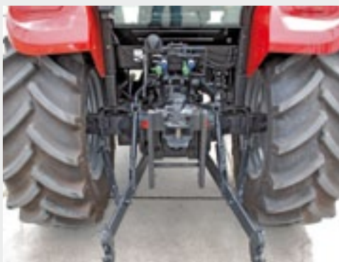
De hef tilt maximaal 2.150 kg. Er kunnen maximaal drie hydraulische ventielen op.
