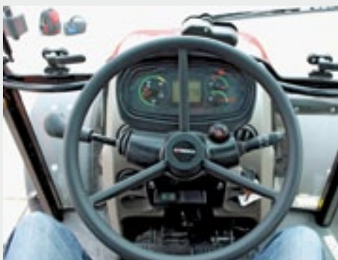
Het instrumentenpaneel zit aan de verstelbare stuurkolom,
