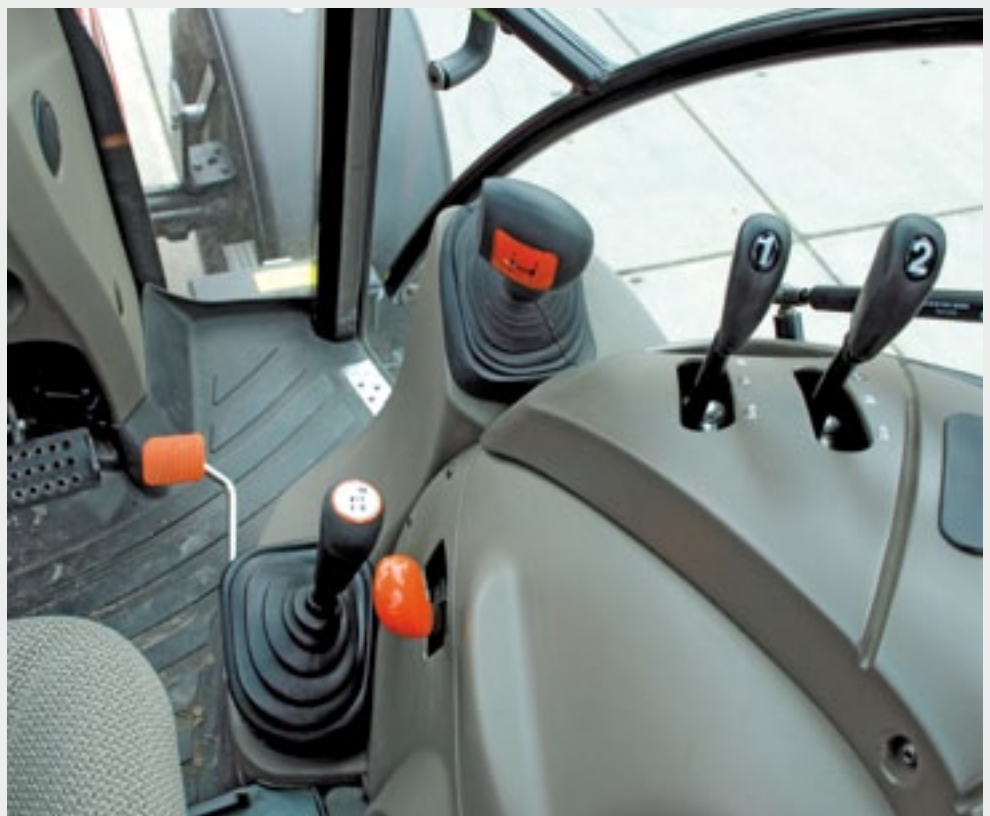
De bedieningselementen aan de rechterkant met een grote versnellingspook, groepenhendel en twee hendels voor de hydrauliek. De oranje hendel in het midden is handgas.
