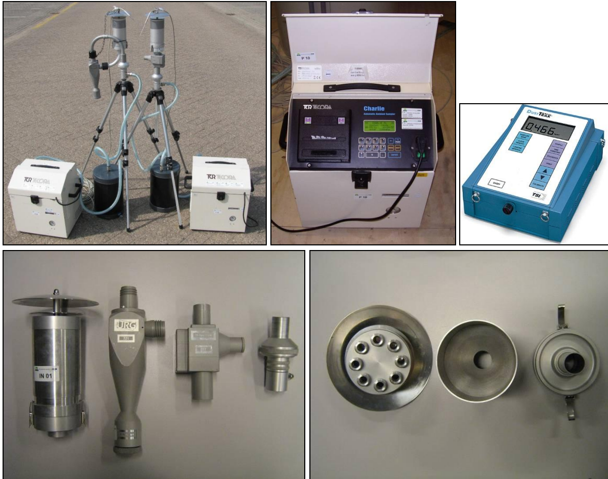
Figuur 1 Monsterrapparaat voor PM10 en PM2,5. Linksonder: een set apparatuur voor gravimetrische meting van PM10 (linker driepoot) en PM2,5 (rechter driepoot). Middenboven: detailfoto van de 'constant flow' monsternamepomp. Rechtsboven: de DustTrak model 8520 voor optische en continue metingen van het verloop in PM10 concentratie. Linksonder (van links naar rechts): inlaat, PM10 cycloon, PM2,5 cycloon en filterhouder. Rechtsonder: de constructie van de inlaat
